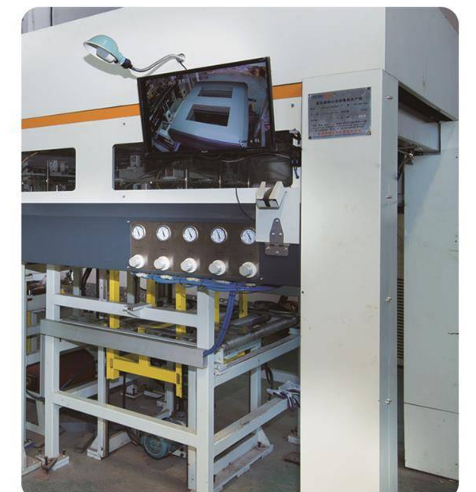
▼ 自动叠装机 automatic core stacking robot
