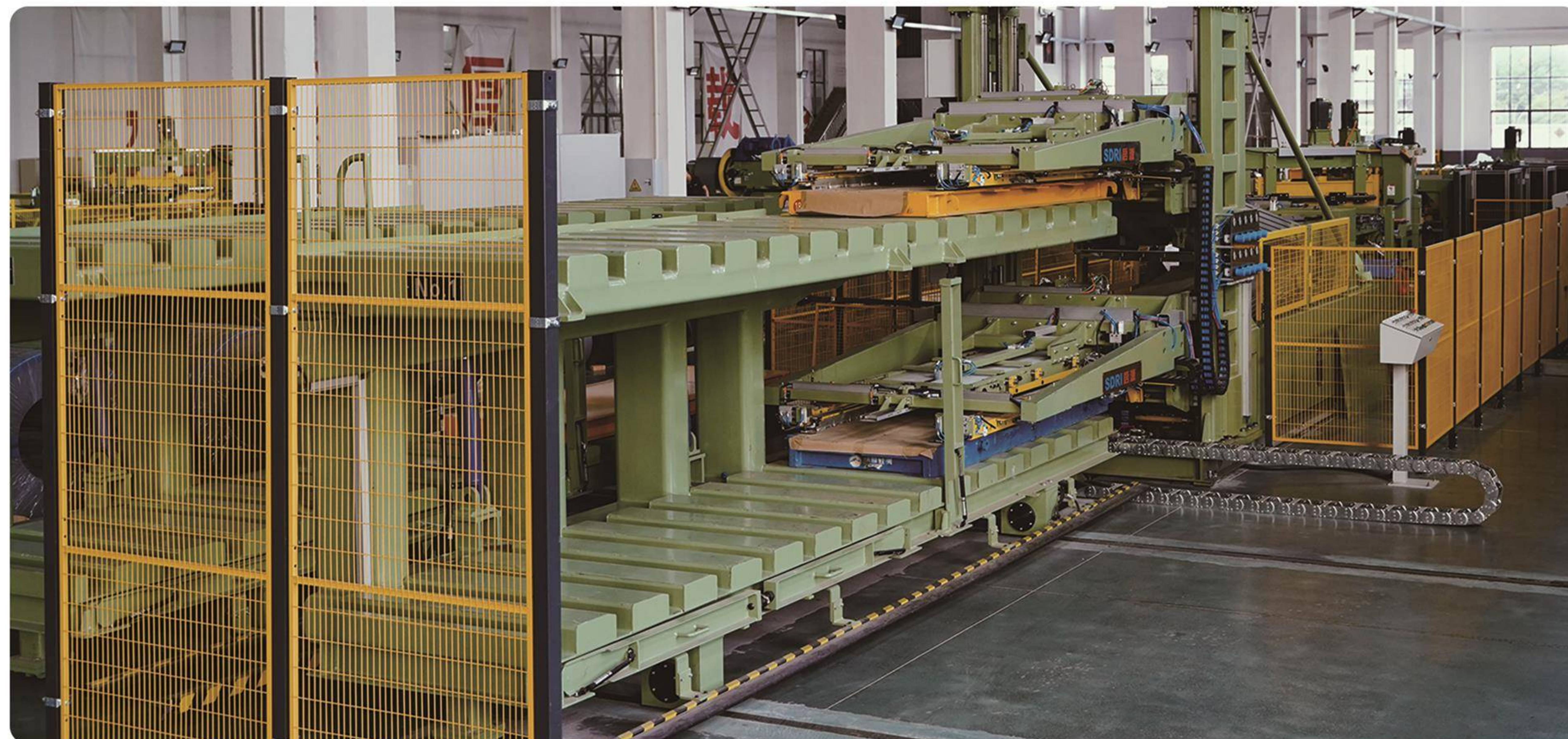
▼ 横剪线: HJX (D262) -800型 cut-to-length line: HJX (D262) -800
